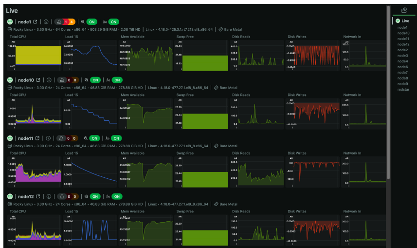
图 16: Netdata展示的各节点监控信息示例。
