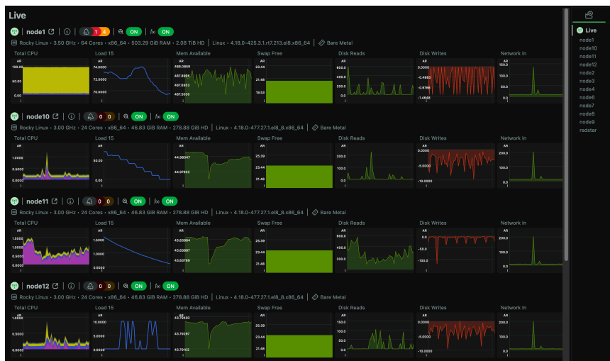
图 16: Netdata展示的各节点监控信息示例。
